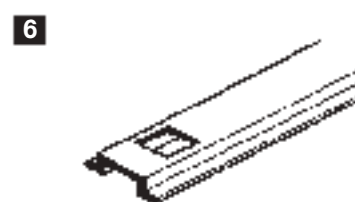
Отверстие для ручки и наконечника Rod hole for handle and rod terminal
