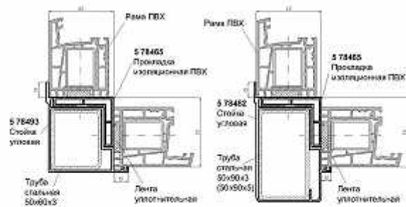
Принцип соединения угловой стойки TS с профилем ПВХ
