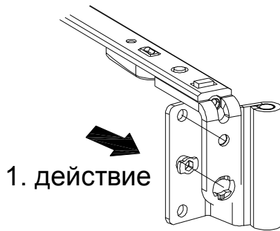
монтаж верхней петли на створке
