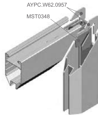
Угловое соединение профилей створки
