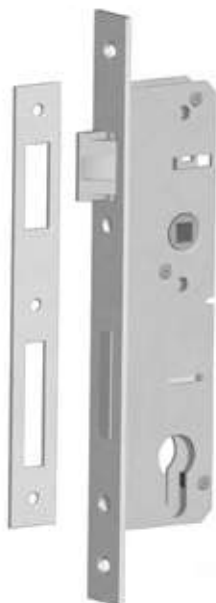
Замок дверной 24/30 с фалевой защёлкой и ответной планкой шириной 24мм. Внимание! Вылет защёлки замка 16,5 мм.
